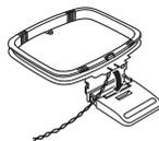
2. Doble la pieza de la base en la dirección indicada.
