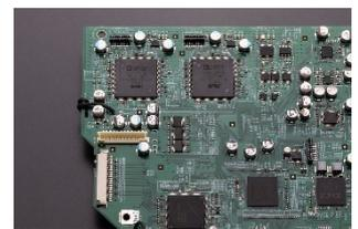
MMM-Stream は、独自のアルゴリズムによって PCM 信号を 1bit DSD データに変換し、後段の MMM-Conversion に送り出します。その過程において行われるオーバーサンプリング、デジタルフィルター、 $\Delta\Sigma$  モジュレーター、ノイズシェーパー、ディザー、レゾネーターなどの処理を全て自社開発のアルゴリズム、パラメーターで行うことにより、マランツの理想とするサウンドを具現化しています。デジタルフィルター切り替え機能を搭載しており、再生する楽曲や好みに合わせてフィルター1 (スローロールオフ) とフィルター2 (シャープロールオフ) を切り替えることができます。MMM-Conversion は MMM-Stream から入力される 1bit DSD 信号をアナログ FIR フィルターによってダイレクトに D/A 変換します。極めてシンプルかつ高品位な回路で D/A 変換を行うことによって原音に忠実なアナログ信号を得ることができます。
