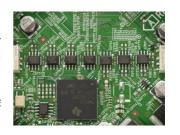
デカップリングコンデンサーを挿入するなど、徹底したノイズ対策により、高周波ノイズによる音質劣化 を防止。クリアで安定したサウンドを実現しました。
